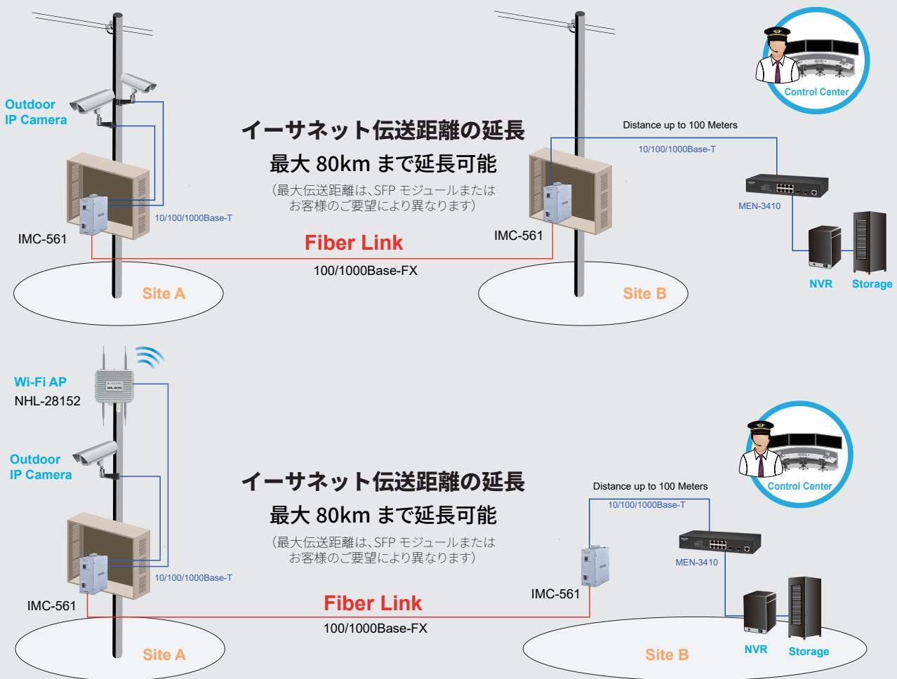
\* この図は、IMC-561 メディアコンバータの代表的なアプリケーション例を示しています。実際の伝送距離は、使用するケーブルの品質や接続する端末機器などの諸条件によって異なります。
